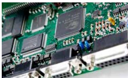
mann. “Los óxidos, cuyo término técnico es escoria, deben ser reemplazados por nuevo material de soldadura.” Con la soldadura selectiva, solo una parte de la placa del circuito está expuesta a la onda de soldadura.
