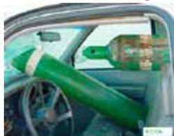
Uma fuga de gás de acetileno da válvula de uma garrafa ficou presa no interior de uma furgoneta. O condutor escapou por pouco. O veículo ardeu em apenas dois minutos.
